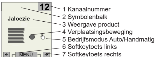
Abb. 1 Display in de bedrijfsmodus (voorbeeld 1): kanaal 12, voordien ingevuld tekstveld 1 "Jaloezie", pictogram "geteachte jaloezie", verplaatsingsbeweging toestand STOP, bedrijfsmodus handmatig
