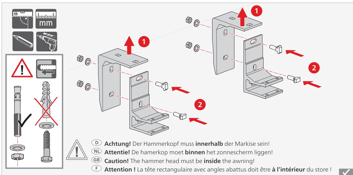
**D Montage der Konsolen an Dachsparrenhaltern (Option)**
