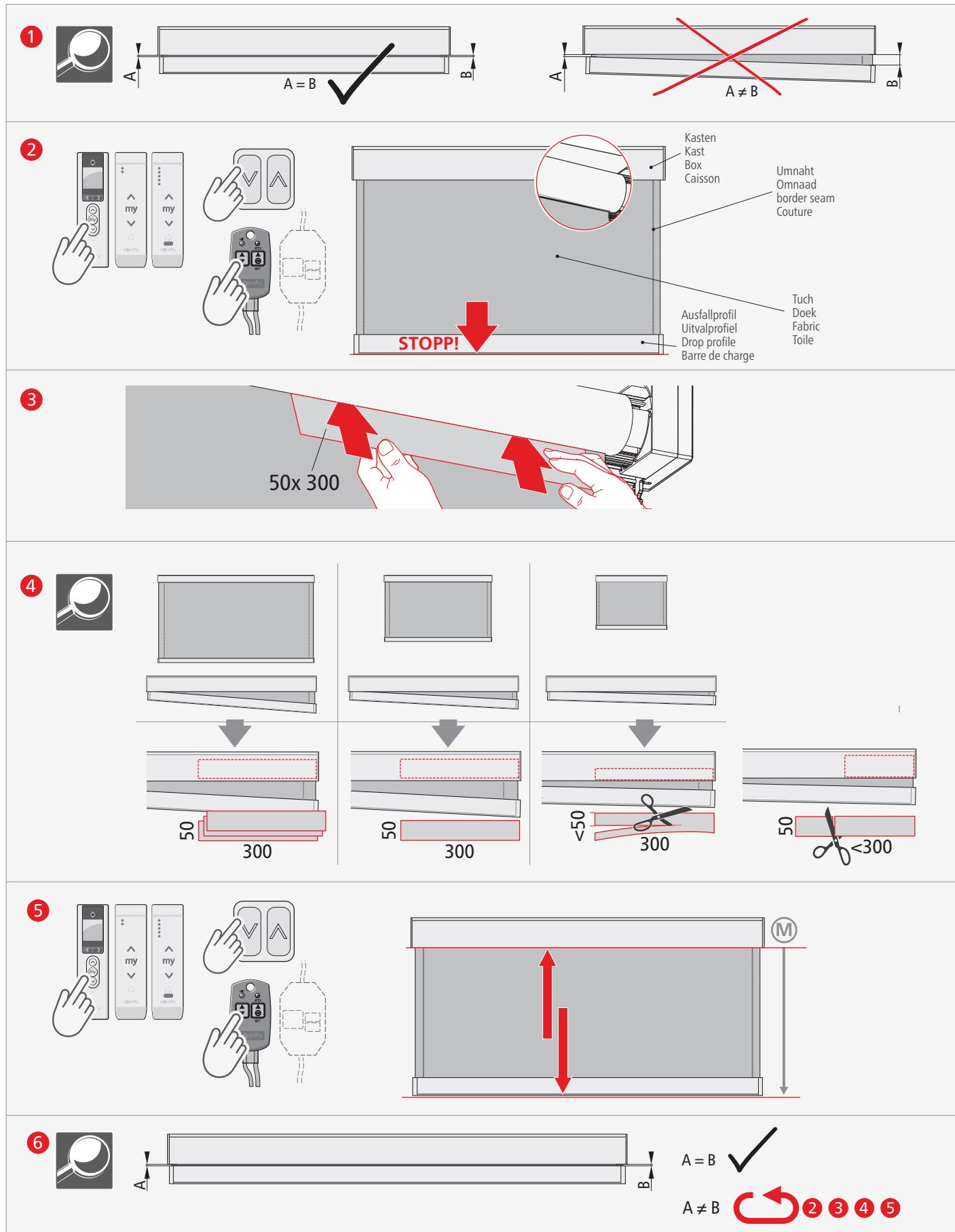
**D Fehlerbild / Ausgangssituation: Ausfallprofil steht im eingefahrenen Zustand nicht parallel zum Kasten.**
