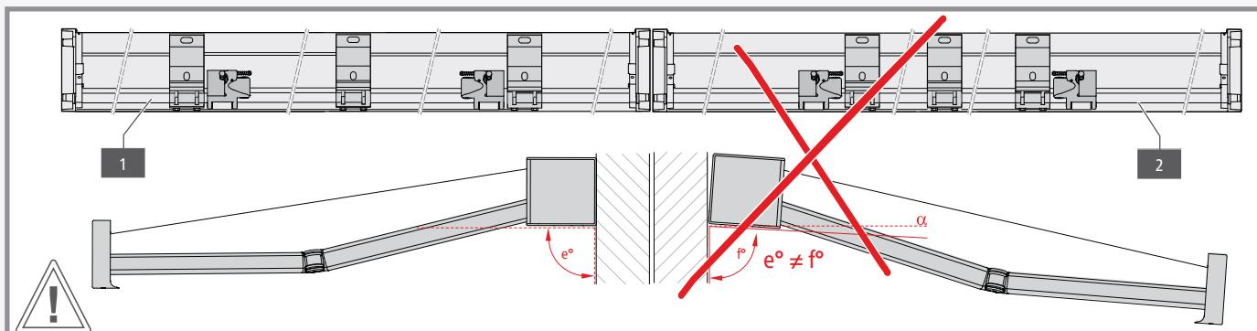
(D) Beachten Sie bei einer Reihenmontage, dass die Konsolen **beider Markisen** entweder innen oder außen vom Bandarm montiert werden müssen, um sicherzustellen, dass der Kasten bündig mit der Wand abschließt. Andernfalls kann es im ausgefahrenen Zustand zu einem leichten Versatz eines Kastens kommen.
